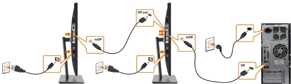
**ПРИМЕЧАНИЕ.** Монитор поддерживает функцию DP MST. Для использования этой функции видеокарта компьютера должна соответствовать спецификации DP1.2 и поддерживать режим MST.
