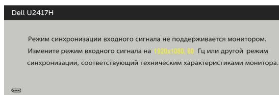
Это означает, что монитор не может произвести синхронизацию с получаемым от компьютера сигналом. Информацию о диапазонах частоты строк и кадров, применимых к данному монитору, см. в разделе [Технические характеристики монитора](#). Рекомендуется разрешение 1920 x 1080.
